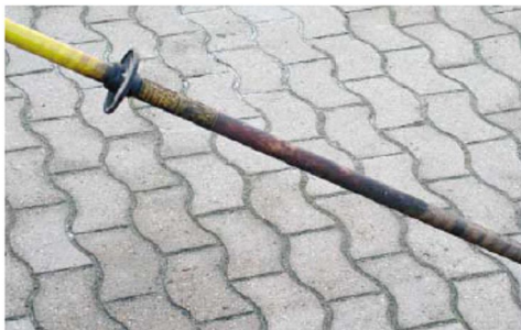
An der isolierten Schaltstange sind deutlich die Brandspuren zu erkennen.
