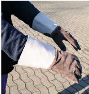
Zum Glück trug die Elektrofachkraft beim Betätigen des 10-kV-Schaltgestänges mit der isolierten Schaltstange solche Handschuhe.
