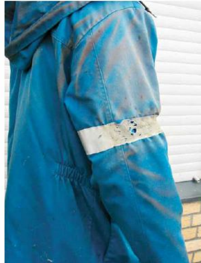
Durch die Hitzeeinwirkung des Störlichtbogens beschädigte Arbeitsjacke.
