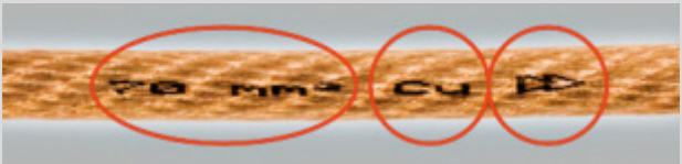
Leiterseil mit Angabe des Querschnitts, des Materials und – bis Juni 2009 – mit dem Doppeldreieck
